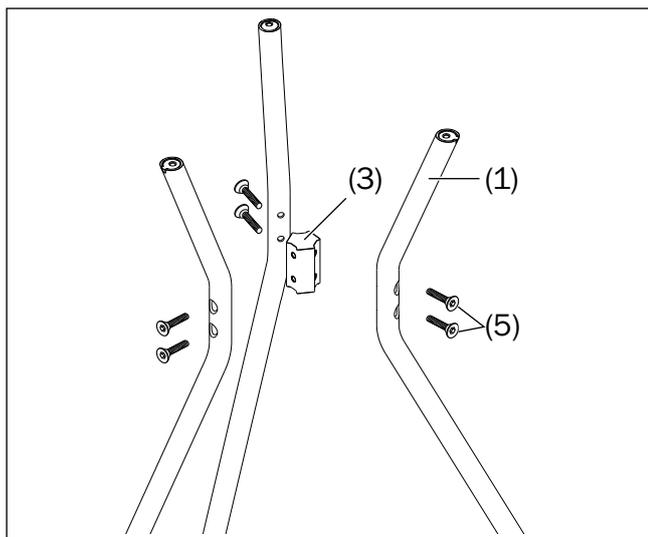
1. Schrauben Sie die drei Standbeine **(1)** mit je zwei Schrauben M4×20 **(5)** an das Verbindungsstück **(3)**.
