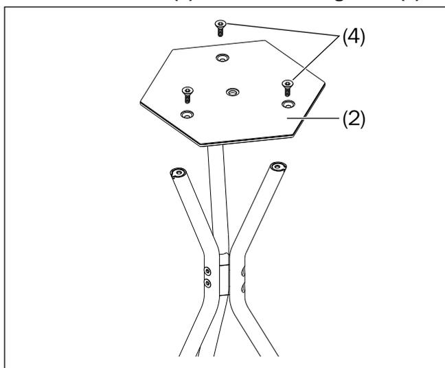
2. Schrauben Sie die Montageplatte **(2)** mit drei Schrauben M4×10 **(4)** auf die montierten Standbeine. Drehen Sie diese Schrauben nicht zu fest, da sonst die Kunststoffgewinde in den Standbeinen beschädigt werden.
