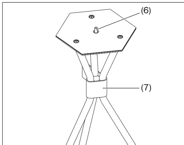
3. Führen Sie die Rändelschraube **(6)** von unten durch die Montageplatte **(2)** und schrauben Sie damit den Holist M auf der Montageplatte fest.
