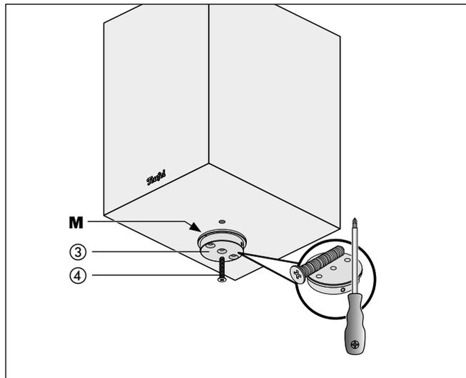
3. Schrauben Sie die Lautsprecherhalterung ③ von unten mit der Schraube ④ auf den Lautsprecher. Dabei muss die Markierung **M** nach vorn weisen.
