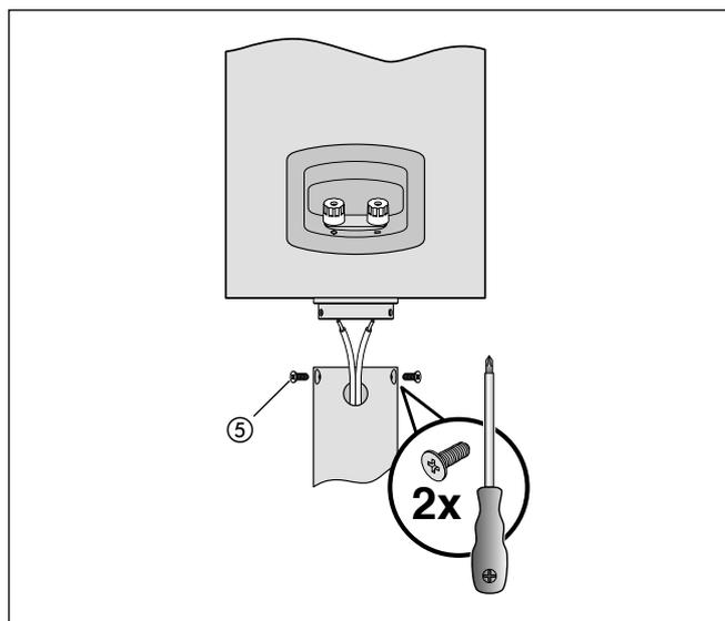
4. Setzen Sie den Lautsprecher mit der Lautsprecherhalterung auf das Rohr und schrauben Sie den Halter durch die Bohrungen am Rohr mit zwei Schrauben ⑤ fest.
