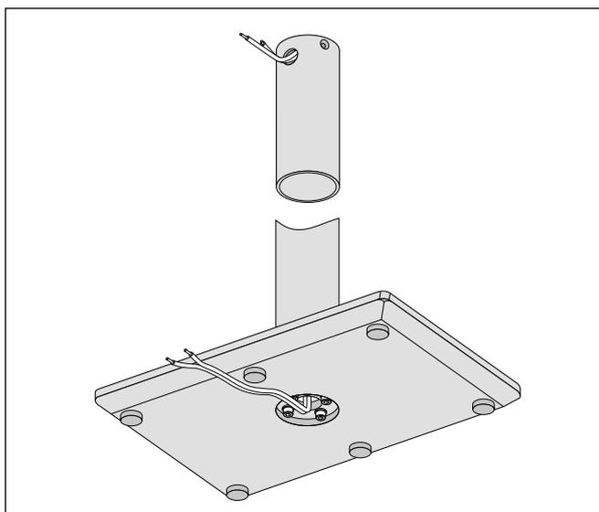
2. Fädeln Sie das Lautsprecherkabel durch das obere Loch durch das Rohr hindurch, bis es aus der Öffnung in der Bodenplatte etwas heraus ragt. Ziehen Sie es dann so weit durch, bis oben noch genügend Länge zum Anschluss des Lautsprechers übrig bleibt.
