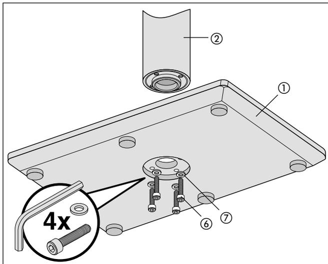
1. Schrauben Sie das Rohr ② mit vier Schrauben ⑥ und vier Unterlegscheiben ⑦ auf der Bodenplatte ① fest. Das große Loch am oberen Ende ist die Kabeldurchführung und sollte nach hinten weisen.
