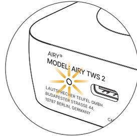
Il indique un niveau de batterie de 21% à 45%. Pendant la charge, le témoin pulse orange.
