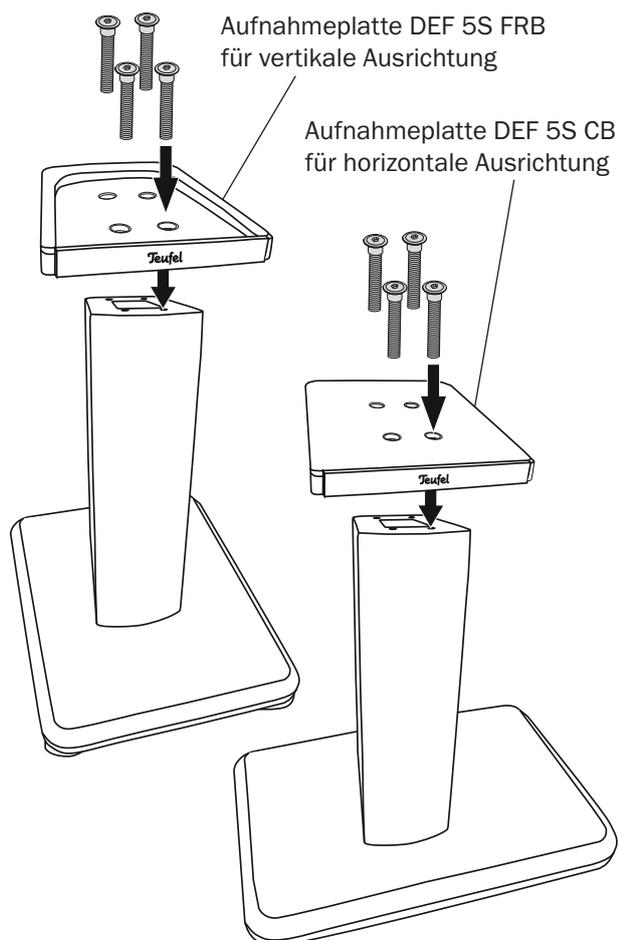
Bevor Sie den Lautsprecher auf den Standfuß montieren, sollten Sie das Lautsprecherkabel verlegen. Dieses Kabel sollte hochwertige Lautsprecher-Doppellitze mit gekennzeichneten Adern sein.
