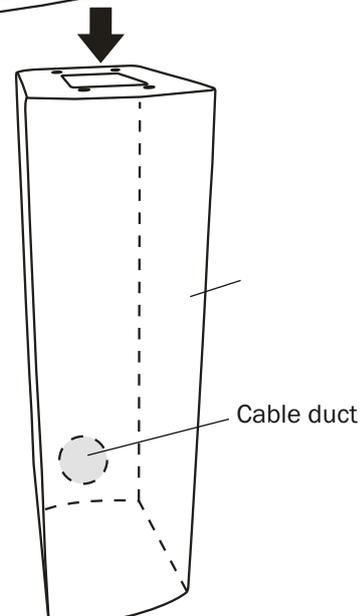
3. Zur Bedämpfung des Lautsprechersystems können Sie die Säule ⑥ mit Quarzsand befüllen. Schrauben Sie zum Abdichten der Säule die Abdeckplatte ⑤ auf die Öffnung der Bodenplatte. Beachten Sie bitte, dass Sie die Lautsprecherkabel dann nicht mehr innerhalb der Säule verlegen können.
