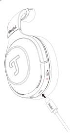
Utilizzare il cavo type-c in dotazione per collegare la porta USB-C **4** sulle cuffie con una porta USB su un PC o con un alimentatore USB. Durante la ricarica, il LED di stato pulsa in giallo. Quando le cuffie sono completamente cariche, il LED di stato si accende in bianco e si spegne gradualmente dopo 1 minuto.
