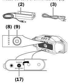
I quattro LED bianchi dell'indicatore della batteria ricaricabile **(8)** segnalano che la ricarica è in corso:
