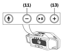
Premendoli brevemente è possibile modificare il volume gradualmente passando da un livello a un altro. Premendo a lungo, il volume si modifica in modo continuo.
