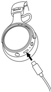
1. Verwenden Sie das mitgelieferte USB-Kabel, um den USB-C-Anschluss **4** des Kopfhörers mit einem USB-Anschluss an einem PC oder einem USB-Netzteil zu verbinden. Je nach aktuellem Ladestand pulsiert die LED **3** während des Ladevorgangs rot (0–20 %), gelb (21–44 %) oder grün (45–99 %). Sobald der Akku vollständig geladen wurde, leuchtet die LED ca. 1 Minute lang grün und geht dann aus. Je nach Leistung der verwendeten USB-Verbindung kann das vollständige Laden bis zu 2 Stunden dauern.
