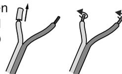
6. Drehen Sie die Anschlussklemme gegen den Uhrzeigersinn los. Führen Sie das abisolierte Kabelende in das nun sichtbare Loch ein. Drehen Sie die Klemme im Uhrzeigersinn zu. Damit ist das Kabel festgeklemmt.
