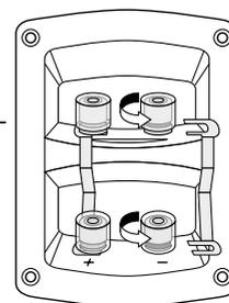
5. Teilen Sie die Litze an beiden Enden auf etwa 30 mm und entfernen Sie jeweils ca. 10 mm der Isolierung. Verdrehen Sie die Litze, damit keine Adern herausstehen.
