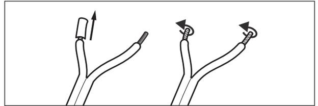
3. Teilen Sie die Litze an beiden Enden auf etwa 30 mm und entfernen Sie jeweils ca. 10 mm der Isolierung. Verdrehen Sie die abisolierten Litzenenden, damit kein Draht heraussteht.
