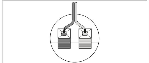
4. Drücken Sie jeweils auf den geriffelten Hebel der Anschlussklemme und führen Sie das abisolierte Litzenende in das nun sichtbare Loch ein. Lassen Sie den Hebel los.
