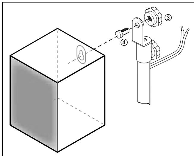
1. Stecken Sie die Halteschraube ④ von vorn in die Lautsprecherhalterung und verschrauben Sie sie zunächst lose mit der Feststellmutter ③.
