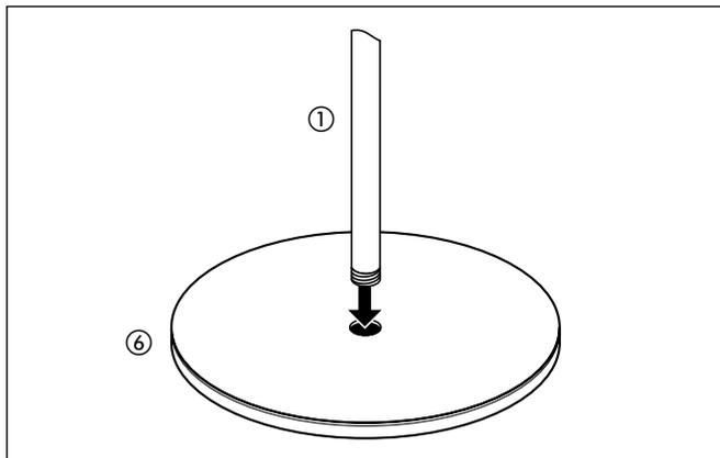
1. Schrauben Sie das Rohr ① in die Bodenplatte ⑥.
