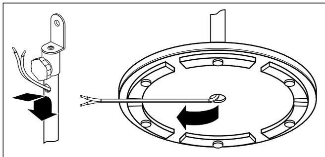
3. Fädeln Sie das Lautsprecherkabel durch das obere Loch durch das Rohr hindurch, bis es aus der Öffnung in der Bodenplatte etwas heraus ragt. Ziehen Sie es dann so weit durch, bis oben noch genügend Länge zum Anschluss des Lautsprechers übrig bleibt.
