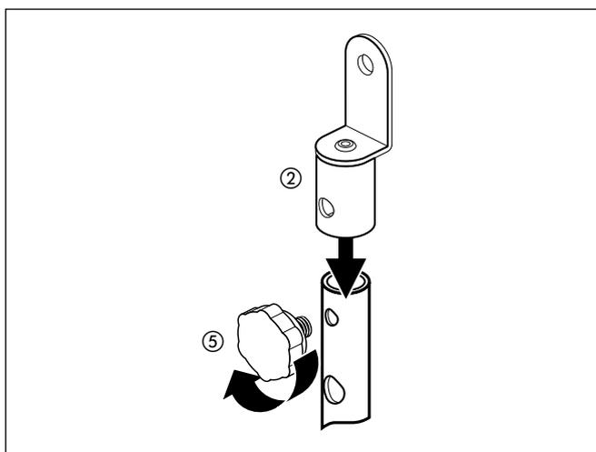
2. Setzen Sie die Lautsprecherhalterung ② auf das obere Ende des Rohres und fixieren Sie sie mit einer Feststellschraube ⑤.
