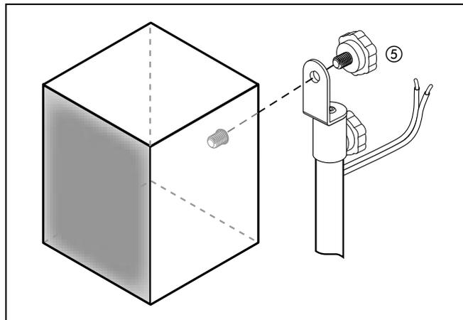
1. Schrauben Sie den Lautsprecher mit der Feststellschraube ⑤ am Standfuß fest.
