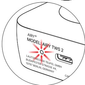
Indica que el nivel de la batería se encuentra por debajo del 20 %. Al cargar, el LED parpadea en rojo.
