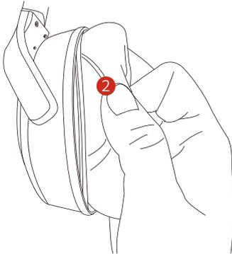
Fassen Sie das Polsterleder (2) direkt an und ziehen Sie es schräg in einem Winkel heraus.
