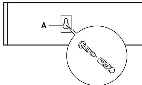
6. Drücken Sie die **Cinebar 21** so gegen die Wand, dass die Schrauben in den Löchern **A** verschwinden. Ziehen Sie die **Cinebar 21** nun nach unten, sodass die Schrauben in den schmalen Schlitz rutschen.
