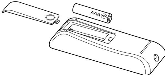
Zum Batteriewechsel den Batteriefachdeckel von der Fernbedienung abziehen, die Batterie auswechseln und den Deckel wieder aufschieben.
