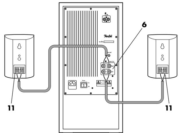
An der Rückseite des Subwoofers befinden sich die Anschlussklemmen **6** „SPEAKER OUT“ für den rechten („Right“) und linken („Left“) Lautsprecher.
