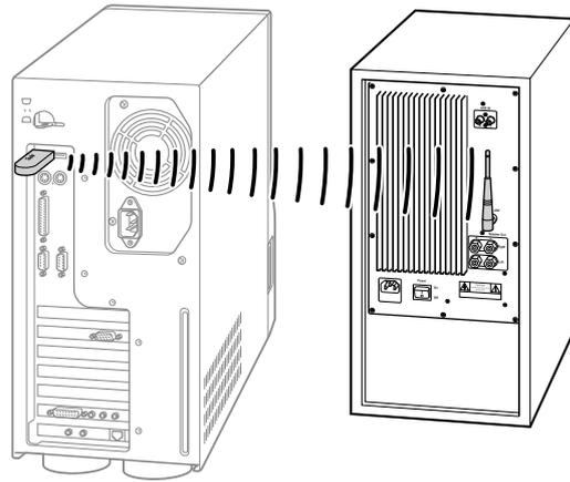
Zum Betrieb der Soundkarte schrauben Sie die Antenne **6** auf die Buchse **5** „2.4GHz ANT“.
