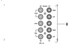
Verlegen Sie Lautsprecherkabel vom Subwoofer zu jedem der Lautsprecher. Dieses Kabel sollte hochwertige Lautsprecher-Doppellitze mit gekennzeichneten Adern sein.
