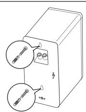
Hängen Sie die Satellitenlautsprecher mithilfe der Schlüsselloch-Öffnungen in der Lautsprecherrückseite und der zuvor montierten Schrauben an der Wand auf.
