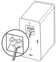
An der Rückseite der Lautsprecher befindet sich jeweils ein Terminal mit einer roten und einer schwarzen Anschlussklemme. Hier können Sie die Lautsprecherkabel direkt oder mittels optionaler Bananenstecker anschlie-Ben. Wir beschreiben hier nur den direkten Anschluss.
