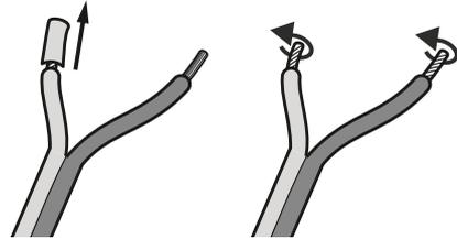
4. Falls Sie steckerlose Lautsprecher-Litze einsetzen, teilen Sie die Litze an beiden Enden auf etwa 30 mm und entfernen Sie jeweils ca. 10 mm der Isolierung. Verdrehen Sie die Litze, damit keine Adern herausstehen.
