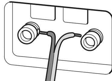
5. Drehen Sie die Anschlussklemme gegen den Uhrzeigersinn los. Führen Sie das abisolierte Kabelende in das nun sichtbare Loch ein. Drehen Sie die Klemme im Uhrzeigersinn zu. Damit ist das Kabel festgeklemmt.
