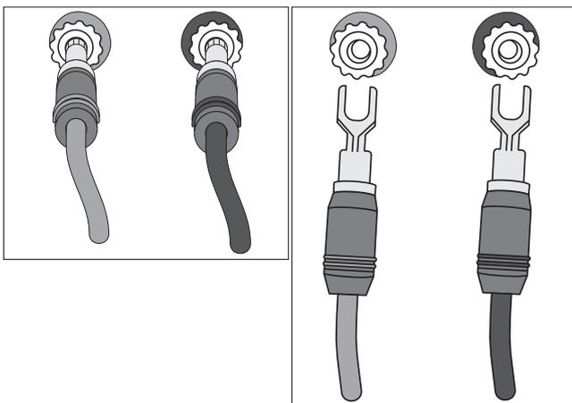
3. Wenn Sie Lautsprecherkabel mit Bananensteckern oder Kabelschuhen aus unserem Sortiment verwenden, stecken Sie die Bananenstecker einfach in die gleichfarbigen Anschlussklemmen. Kabelschuhe werden unter die Klemmen geschoben und angeklemt.
