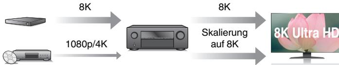
Dieses Gerät ist mit einer Funktion zur Aufwärtsskalierung auf 8K-Video ausgestattet, so dass Sie Videos mit HD (High Definition) 1080p/4K über HDMI mit 8K-Auflösung (7680 × 4320 Pixel) ausgeben können. Mit dieser Funktion können Sie das Gerät über ein einzelnes HDMI-Kabel an einen Fernseher anschließen und so hochauflösende Bilder für jede Videoquelle erzeugen.
