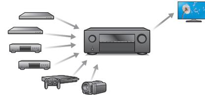
Dieses Gerät verfügt über 6 HDMI-Eingänge und 1 HDMI-Ausgänge, die Verbindungen mit verschiedenen HDMI-kompatiblen Geräten wie Blu-ray Disc-Playern, Spielekonsolen und HD-Videokameras ermöglichen.
