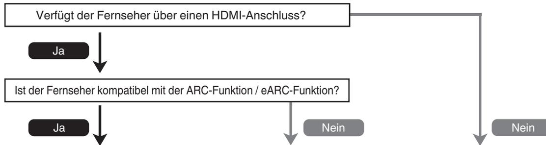
**“Anschlussweise 1: Der Fernseher verfügt über einen HDMI-Anschluss und ist kompatibel mit ARC (Audio Return Channel) / eARC (Enhanced Audio Return Channel)”** (☞ S. 34)
