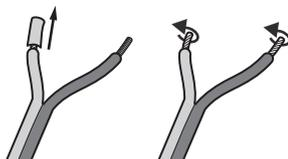
1. Teilen Sie die Litze an beiden Enden auf etwa 30 mm und entfernen Sie jeweils ca. 10 mm der Isolierung.
