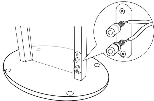
3. Drehen Sie die Anschlussklemme gegen den Uhrzeigersinn los. Führen Sie das abisolierte Kabelende in das nun sichtbare Loch ein. Drehen Sie die Klemme im Uhrzeigersinn zu. Damit ist das Kabel festgeklemmt.
