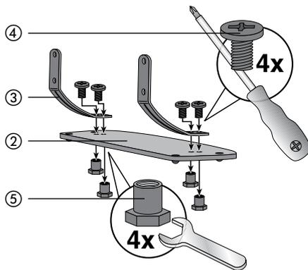
2. den Lautsprecher ① mit vier Schrauben ④ an den Haltern ③ festschrauben.
