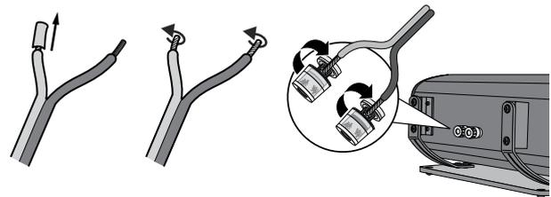
1. Teilen Sie die Litze an beiden Enden auf etwa 30 mm und entfernen Sie jeweils ca. 10 mm der Isolierung.
