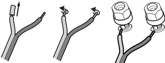
2. Teilen Sie die Lautsprecherkabel an beiden Enden auf etwa 30 mm und entfernen Sie jeweils ca. 10 mm der Isolierung.
