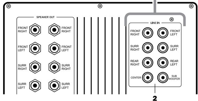
Bei einem 5.1-System werden die Eingangsbuchsen Rear Right und Rear Left am Subwoofer nicht belegt.
