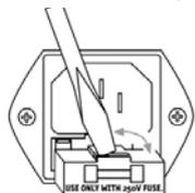
Leuchtet keine Power-Lampe auf der Rückseite, tauschen Sie bitte die Sicherung gegen eine gleichwertige aus (siehe Seite 14, Position 5).
