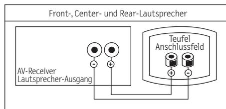
Schließen Sie bei einem 5.1-Receiver die Front-, Center- und Rear-Lautsprecher gemäß der Zeichnung an.
