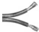
Hochflexible Kupferlitze (650 Adern) mit durchsichtiger Ummantelung und Markierung für richtige Polung. Das 2 x 2,5 mm<sup>2</sup>-Kabel kann bis zu einer Streckenlänge von 15 Metern verwendet werden, bei längeren Kabelstrecken empfehlen wir das stärkere 2 x 4 mm<sup>2</sup>-Kabel. Auf vielfachen Kundenwunsch ist unser Kabel auf praxisnahe Längen vorkonfektioniert.
