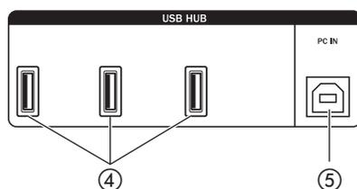
Die Buchse ⑤ verbinden Sie mit einem USB-Anschluss Ihres PC. Verwenden Sie dazu das mitgelieferte USB-Kabel oder ein vergleichbares (Typ A/B). Das Kabel sollte möglichst kurz sein.
