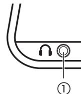
Beim Anschließen des Kopfhörers werden die Lautsprecher automatisch ausgeschaltet.
