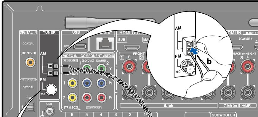
Schließen Sie die Antenne an dieses Gerät an und richten Sie die Antenne in die beste Position zum Hören aus, während Sie Radiosignale empfangen. Befestigen Sie die FM-Zimmerantenne mit Druckstiften oder Klebeband an der Wand.
