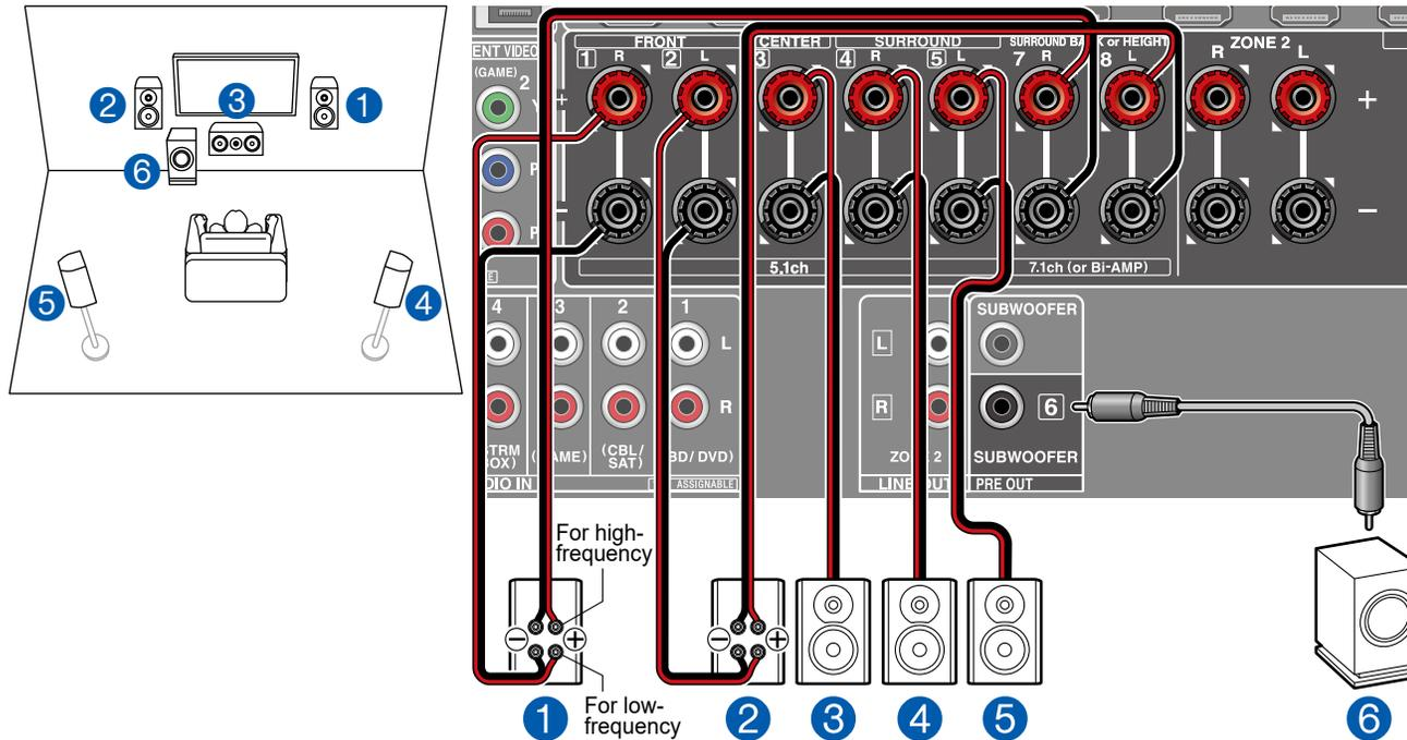
Sie können ein 5.1-Kanalsystem (→p14) konfigurieren, indem Sie Frontlautsprecher anschließen, die eine Bi-Amping-Verbindung unterstützen. Die Bi-Amping-Verbindung kann die Qualität der niedrigen und hohen Bereiche verbessern. Stellen Sie sicher, dass die Leitungsbrücke zwischen den Tieftönerbuchsen und den Hochtönerbuchsen der Frontlautsprecher, die eine Bi-Amping-Verbindung unterstützen, entfernt werden. Entsprechende Informationen finden Sie auch in der Bedienungsanleitung Ihrer Lautsprecher.
