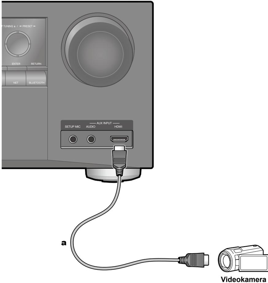
Schließen Sie eine Videokamera usw. an die AUX INPUT AUDIO/HDMI-Buchse am Bedienfeld mit einem HDMI-Kabel oder einem Stereo-Minsteckerkabel ( $\varnothing 1/8''/3,5$  mm) an.
