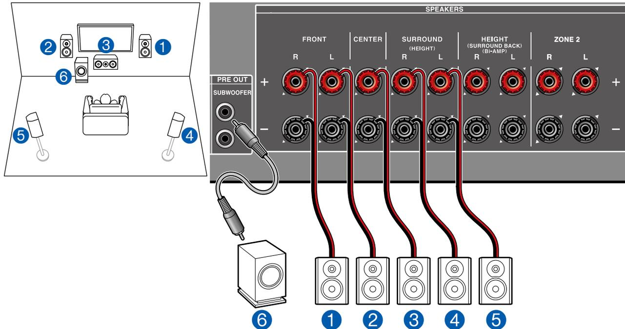
Das ist ein Basis-5.1-Kanalsystem. Für Einzelheiten der Lautsprecherkonfiguration lesen Sie bitte "Lautsprecherinstallation" (→[p20](#)).
