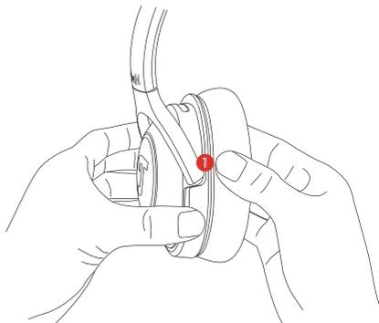
Veuillez tenir fermement l'oreillette d'une main (1) pendant le remplacement, car l'articulation pivotante pourrait se casser si une pression excessive lui est appliquée.
