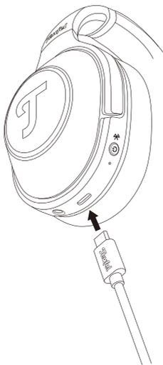
Verbinden Sie den USB-C-Anschluss **3** des Kopfhörers mit dem beiliegenden USB-C-Kabel mit einem USB-Anschluss am PC oder einem USB-Ladegerät.
