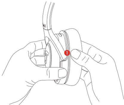
Bitte halten Sie die Hörmuschel während des Wechsels mit einer Hand (1) fest, da das Drehgelenk bei zu starkem Druck brechen kann.
