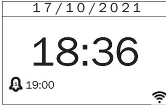
En caso de reproducción, la pantalla está dividida en tres: En la parte superior se muestra la fuente y la hora. En la parte central, información sobre la reproducción. En la parte inferior, el estado de las horas del despertador, la fuente y las conexiones por radio.
