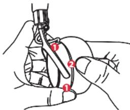
Tenere saldamente il padiglione auricolare con una mano (1) durante la sostituzione, poiché il giunto girevole potrebbe rompersi se viene applicata troppa pressione.
