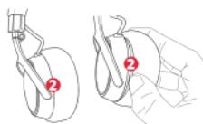
Beginnen Sie an der Oberseite des Polsters (2) und gehen Sie dann z. B. mit dem Daumennagel zwischen das Polster und den Kopfhörer. Auf diese Weise können Sie das Polster schrittweise entfernen.
