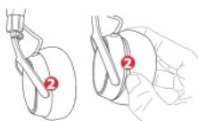
Begin aan de bovenkant van het kussen (2) en druk de duim of duimnagel tussen het kussen en de headset. Op deze manier kan het kussen probleemloos worden verwijderd.
