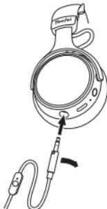
1. Le câble de connexion fourni comprend deux fiches jack 3,5 mm. Insérez la fiche jack 3,5 mm crantée dans la prise jack 3,5 mm **5** du casque. Veillez à ce que la télécommande du câble soit plus proche du casque que de votre système audio ou smartphone.
