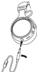
1. Dołączony do zestawu kabel audio ma dwa 3,5 mm wtyki typu jack. Wsuń karbowany 3,5 mm wtyk do 3,5 mm gniazda typu jack **5** w słuchawkach. Upewnij się, że pokrętło sterowania zdalnego znajduje się bliżej słuchawek niż systemu audio lub smartfona.
