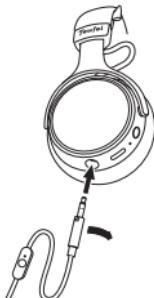
1. El cable de conexión incluido tiene dos conectores de 3,5 mm. Inserte el conector de 3,5 mm con muesca en la toma de 3,5 mm **5** de los auriculares. Asegúrese de que el cable de control remoto esté más cerca de los auriculares que su sistema de audio o teléfono inteligente.
