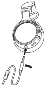
1. De bijgeleverde connectorkabel heeft twee 3,5 mm stekkers. Steek de gekerfde 3,5 mm stekker in de 3,5 mm ingang **5** van de koptelefoon. Zorg ervoor dat de afstandsbedieningkabel dichter bij de koptelefoon is dan bij uw audiosysteem of smartphone.
