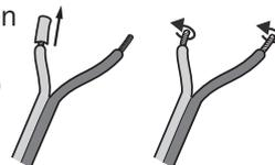
5. Drehen Sie die Anschlussklemme gegen den Uhrzeigersinn los. Führen Sie das abisolierte Kabelende in das nun sichtbare Loch ein. Drehen Sie die Klemme im Uhrzeigersinn zu. Damit ist das Kabel festgeklemmt.
