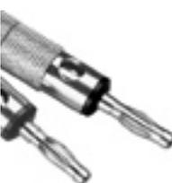
Diese hochwertigen Teufel-Allroundstecker ermöglichen einen genauso preiswerten wie sicheren Anschluss Ihrer Lautsprecher an Verstärker oder Receiver. Eine stabile Schraubklemme hat alle Kabel mit einem Durchmesser von bis zu 10 mm fest im Griff. Dauerelastische Federkontakte und eine echte Goldbeschichtung garantieren sehr widerstandsarme Steckverbindungen. Lieferung paarweise, jeweils ein Stecker rot und ein Stecker schwarz markiert. Für das Theater 1 benötigen Sie 10 Stück.
