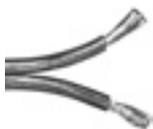
Hochflexible Kupferlitze (650 Adern) mit durchsichtiger Ummantelung und Markierung für richtige Polung. Das 2 x 2,5 mm<sup>2</sup>-Kabel kann bis zu einer Streckenlänge von 15 Metern verwendet werden, bei längeren Kabelstrecken empfehlen wir das stärkere 2 x 4 mm<sup>2</sup>-Kabel. Auf vielfachen Kundenwunsch ist unser Kabel auf praxisnahe Längen vorkonfektioniert.
