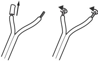
3. Teilen Sie die Litze an beiden Enden auf etwa 30 mm und entfernen Sie jeweils ca. 10 mm der Isolierung.
