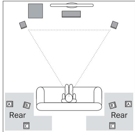
Die Rear-Lautsprecher werden seitlich oder rückwärtig vom Zuhörer in einer Höhe von 1,20 m bis 2,10 m aufgestellt oder aufgehängt (siehe graue Bereiche in der Grafik).
