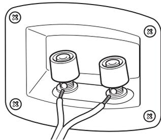
An der Rückseite jedes Lautsprechers befindet sich ein Anschlussterminal mit zwei Klemmen, an die Sie die Lautsprecherkabel anschließen müssen.
