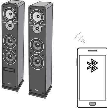
El sistema de radio por Bluetooth® tiene un alcance de aprox. 10 metros que puede verse afectado por paredes o mobiliario. En caso de que la conexión se interrumpa, el ULTIMA 40 ACTIVE NG intentará establecer una nueva conexión hasta que usted seleccione otra fuente.
