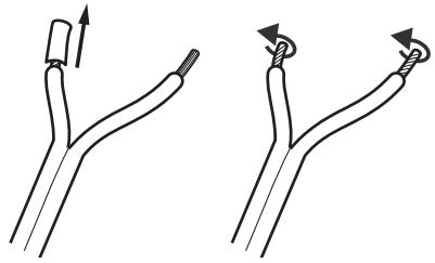
4. Desserrez les bornes de branchement dans le sens inverse des aiguilles d'une montre. Introduisez les extrémités dénudées dans les trous visibles. Tournez les bornes dans le sens des aiguilles d'une montre. Et maintenant, le câble de haut-parleur est branché.
