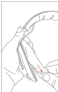
Tenere in posizione la parte superiore già inserita e tirare ed inserire la parte inferiore.
